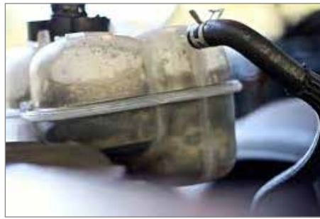
Abbildung 1. Kühlmittel Tank – optischer Eindruck durch vermutzte Kühlflüssigkeit
