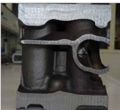
Abbildung 8. Gussoberfläche direkt nach dem Strahlen
