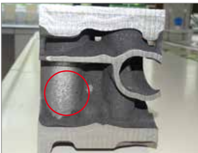
Abbildung 7. Nur Gussquerschnitt nach dem Ausrütteln
